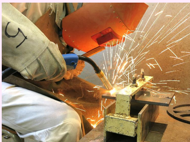
半自動溶接実習
