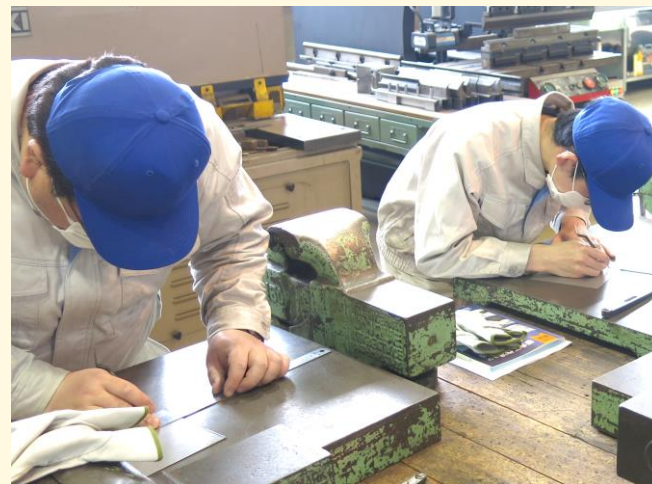
板金実習（ケガキ実習）
